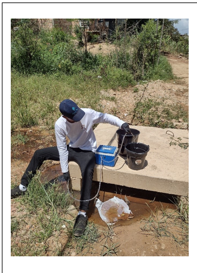
Figura 4.– Aparato desenvolvido pela RMPC que permite a coleta de amostras de água em microhabitats rasos, onde é impossível a coleta com balde. A novidade evita distúrbios na coleta que podem modificar a qualidade de água e causar erros nos resultados.
